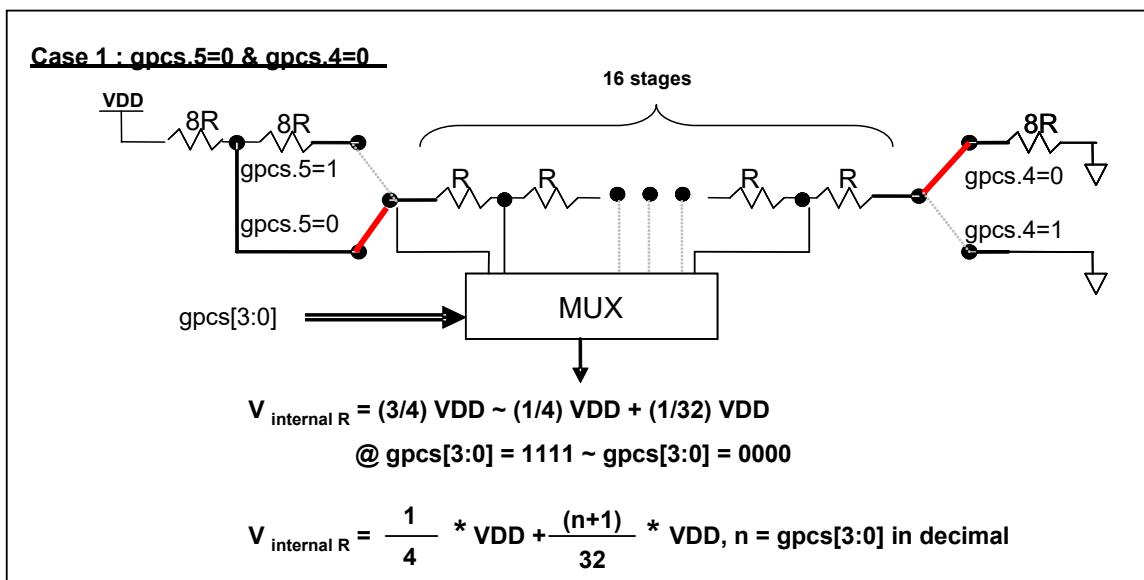
图 5:  $V_{internal\ R}$  硬件接法(gpcs.5=0 & gpcs.4=0)
