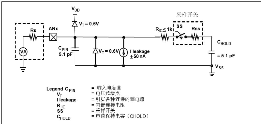
图 20: 模拟输入模型
