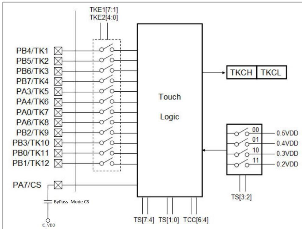
图 16：触摸检测电路的功能方框图
