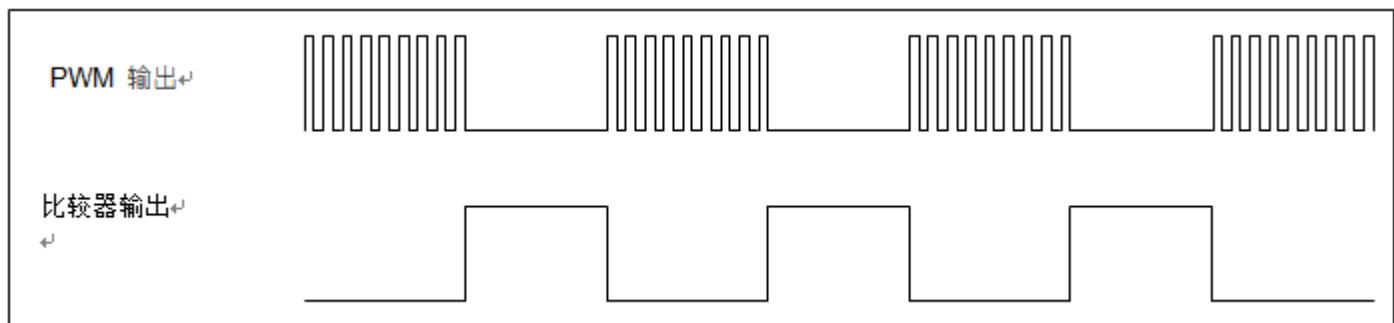
图 15: 比较器控制 PWM 输出
