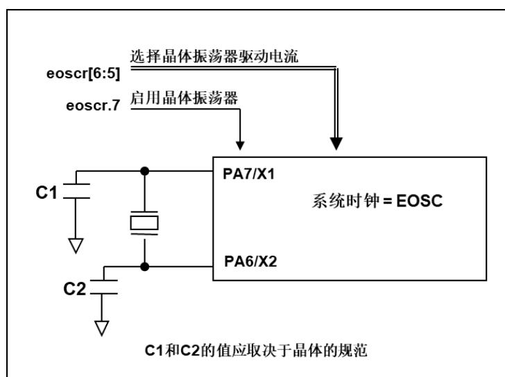
图 2: 晶体振荡器的硬件连接
