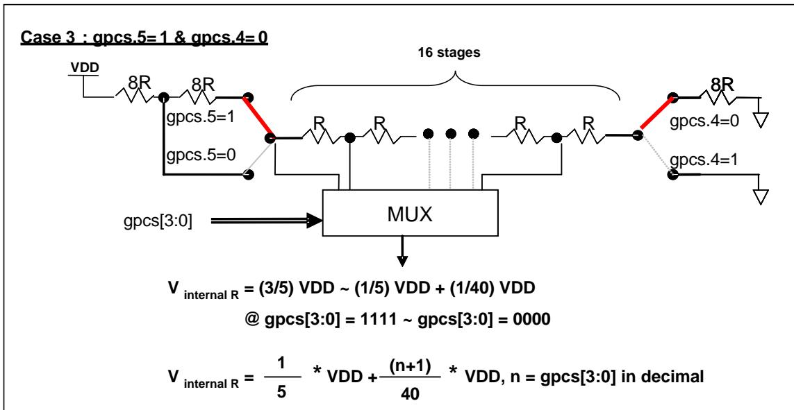
图 7:  $V_{internal\ R}$  硬件接法(gpcs.5=1 & gpcs.4=0)
