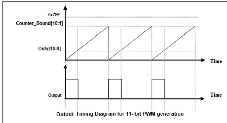
图 16: 11 位 PWM 生成器输出时序图
