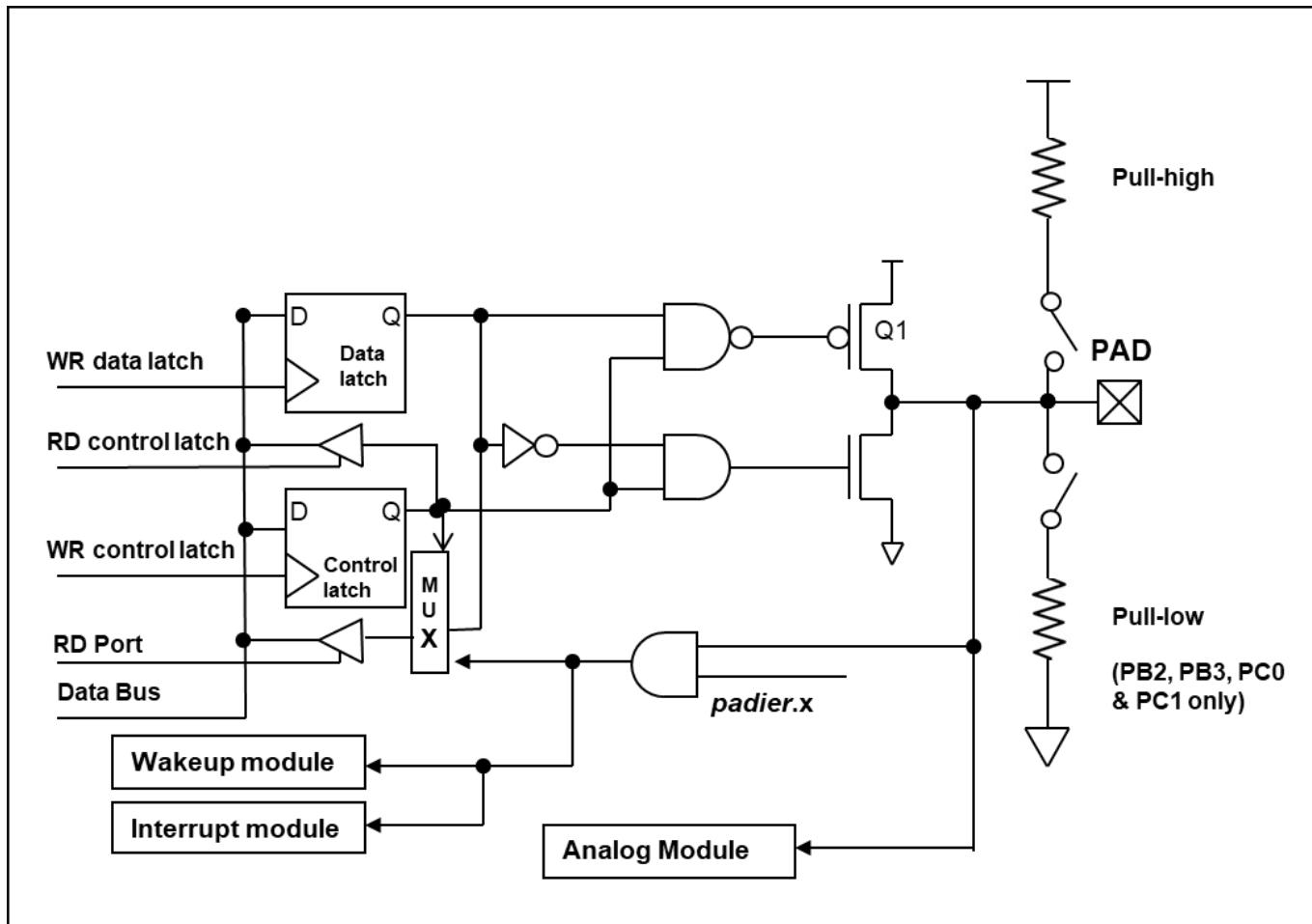
图 21: IO 引脚缓冲区硬件图
