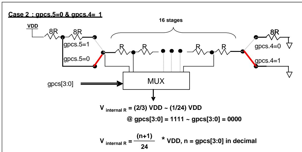
图 6:  $V_{internal\ R}$  硬件接法( $gpcs.5=0$  &  $gpcs.4=1$ )
