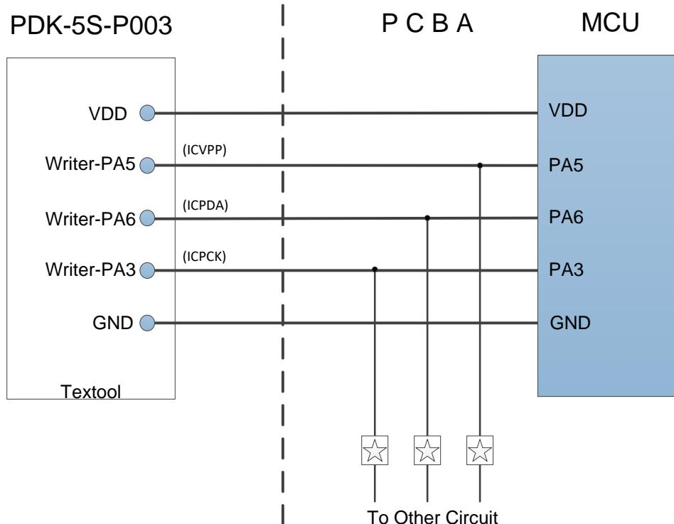
上图为 PFS123 在板烧录时接线示意图。图中的  $\star$  为电阻或电容，用于隔离烧录引线和其他电路。电阻应 $\geq 10\text{K}\Omega$ ，电容应 $\leq 220\text{pF}$ 。
