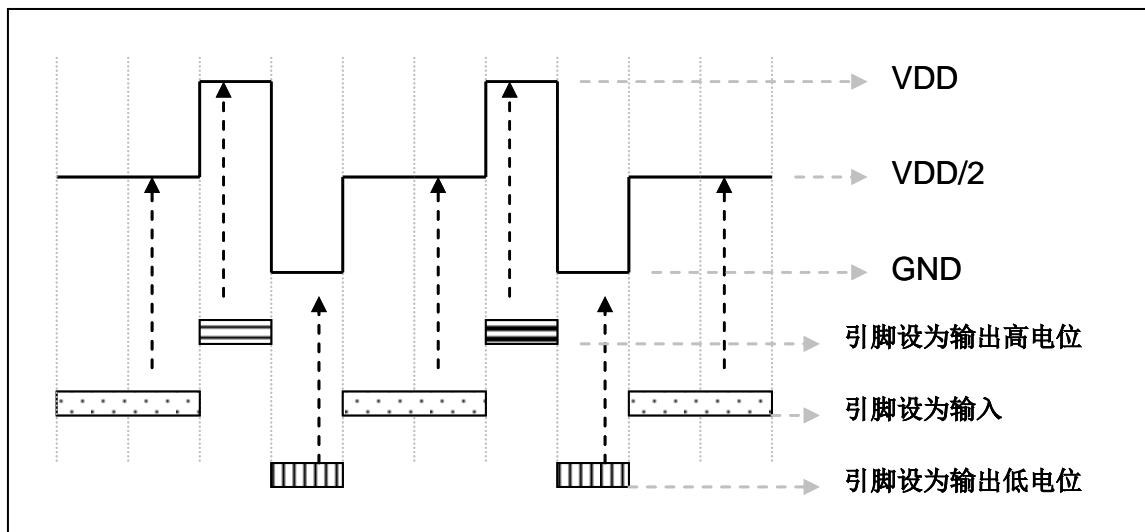
图 9: 使用 VDD/2 LCD bias 电压生成器
