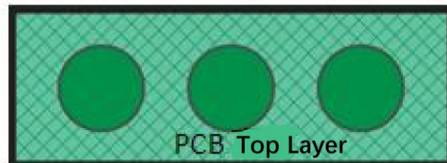
图五：顶层按键感应盘之外铺网格铜
